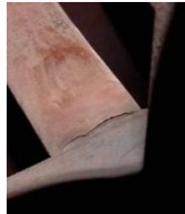
Tube-to-header crack in HRSG
